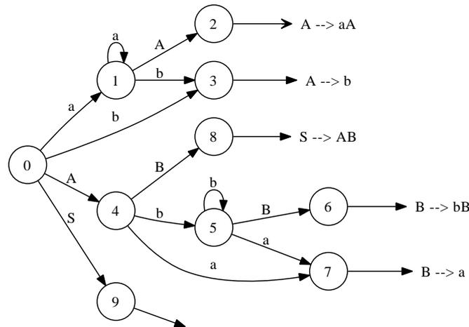
FIG. 3.11 – Automate des réductions licites
